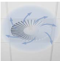
Drallförmige, horizontale Luftführung
